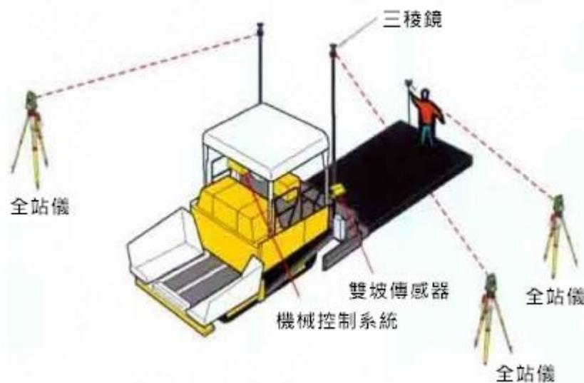
Leica PaveSmart 3D 系統是革命性的鋪面控制系統，它消除了放樣、掛線等傳統施工中產生的人為誤差，創新的 3D 智能鋪面控制系統，不再需要設置引導線，省去了打樁拉線帶來的成本和不便，為您的鋪面施工工程提供前所未有的靈活性和機動性！全自動 3D 智能鋪面控制系統的縱向和橫向控制，使任何複雜的鋪面施工都能夠精準控制，實現設置快速、簡單易用和井然有序的施工現場，Leica PaveSmart 3D 是您鋪面工程的最佳選擇!!
